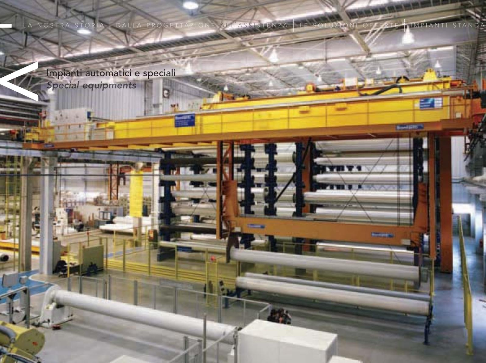
Magazzino automatico bobine film plastico.
